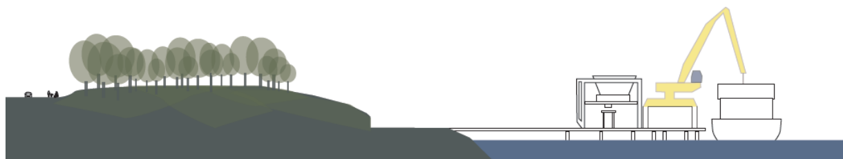
Principsektion hamn. Kyrkhamnsvägen till vänster. Kaj på pålar i Mälaren med kranar som lyfter bränsle från fartyg till transportband. Illustration: Liljewall Arkitekter.
