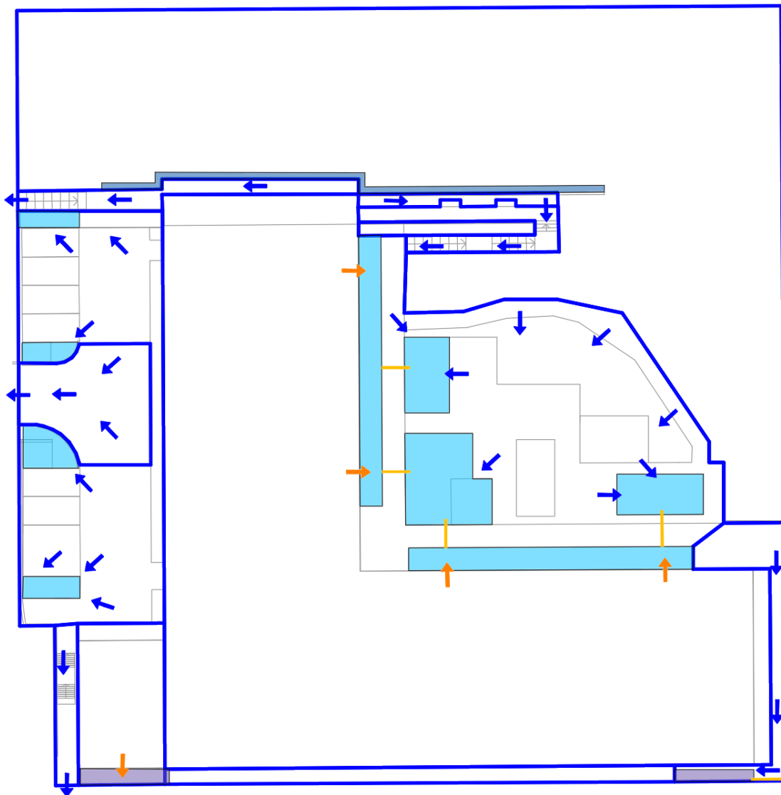
Figur 12 Avrinning till dagvattenanläggningar inom respektive avrinningsområde
