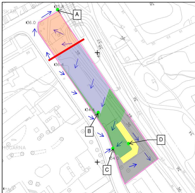
Figur 8. Befintliga avrinningsområden redovisas med separata färger. Befintliga anslutningspunkter A-D redovisas med grön cirkel. Yttlig avrinning illustreras med blå pilar. Gräns för utredningsområdet redovisas med rosa linje. Höjdrygg/vattendelare visas med röd linje. Grått område ansluter inte till ledningsnätet utan avrinner yttligt åt söder.
