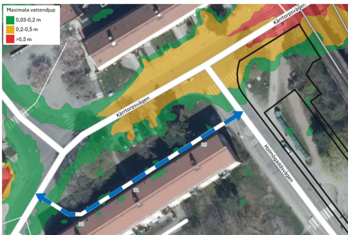
Figur 19. Urklipp från Scalgo med Stockholms stads modellresultat. Figuren visar maximala vattendjup och möjlig alternativ tillfart till planerad exploatering (blåstreckad linje).
