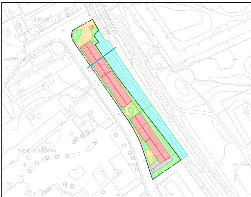
Figur 11. Bilden visar kartering av planerad markanvändning. röd yta = tak, grå yta = asfalt, orange yta = plattor, grön yta = grönyta/skogsmark, blå/cyan yta=grönyta/skogsmark utanför plangräns.
