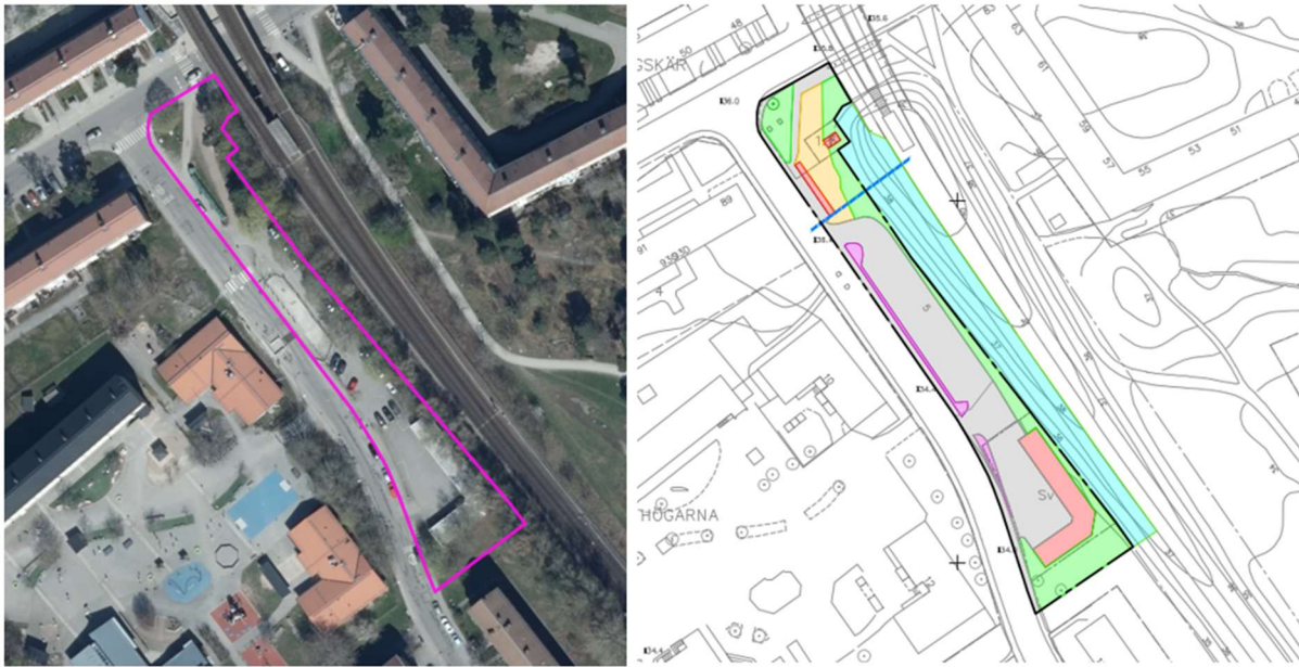
Figur 10. Vänster bild visar en satellitbild över området. Planområdet markerat med rosa linje. (Scalgo, 2026). Höger bild visar kartering av befintlig markanvändning. röd yta = tak, grå yta = asfalt, lila yta = betongmarkplattor, orange yta = grus, grön yta = grönyta/skogsmark, blå yta= grönyta/skogsmark utanför plangräns.
