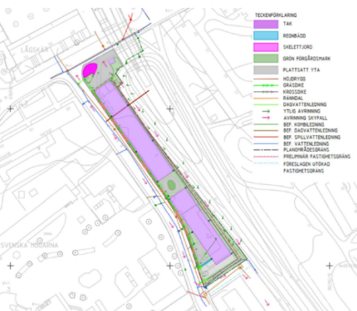
Föreslagen dagvattenhantering. Bild: Markanta
