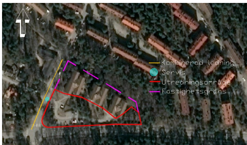
Servisanslutning vid fastighetsgräns som ansluter till kombinerad ledning med fall mot sydväst (Tyréns).
