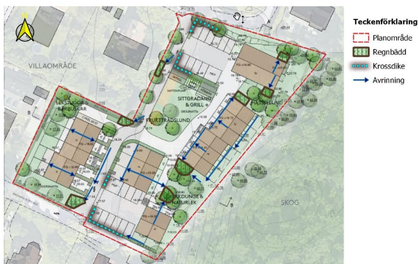
Översiktlig dagvattenlösning för planområdet (Geosigma).
