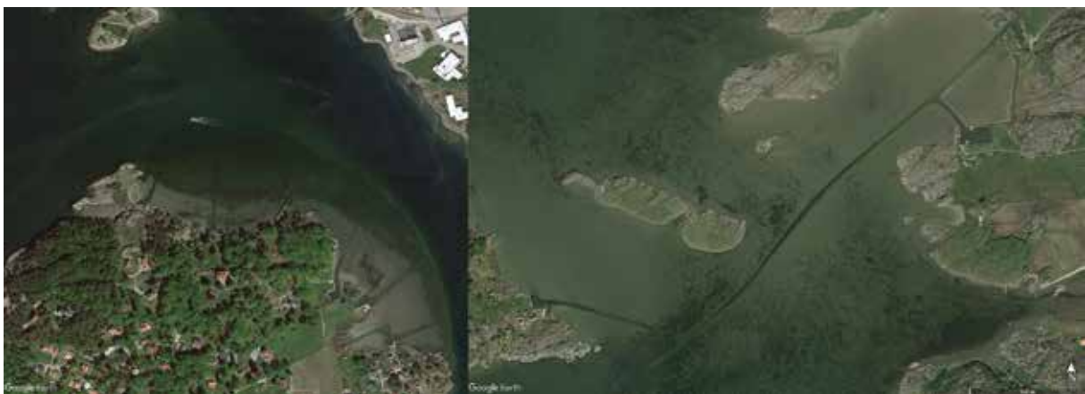
FIGUR 4.2 Muddringsskador runt grunda bryggor på Sveriges västkust. Muddring sker både i direkt anslutning till bryggan, men även för att skapa kanaler in till bryggorna från djupare vatten. Mudderrännorna kan skapa fragmentering av viktiga bottenhabitat, såsom sjögräs. Satellitbilder från Google Earth 7.3.2.5776 [2019–04–23].
