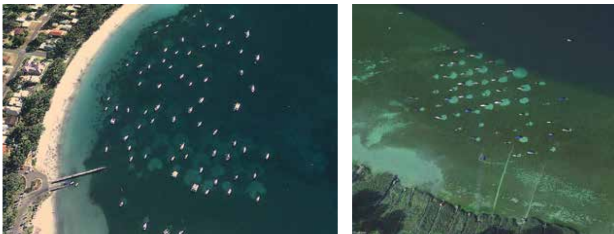
FIGUR 5.4 Direkta skador av bojkättingar syns tydligt i a) sjögräsäng i Jervis Bay vid sydöstra Australiens kust (2009) och b) kransalgäng i Bodensjön på gränsen mellan Tyskland och Schweiz (2012). I båda områdena har man arbetat med att ta fram mer miljövänliga bojsystem. Satellitbilder från Google Earth 7.3.2.5776 [2019–03–23].
