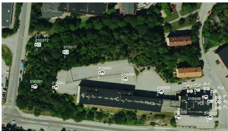
Figur 5. Del av situationsplan, Geosigas initiala undersökning 2021. Provpunkt 21GS01, 21GS11 och 21GS12 är lokaliserade inom aktuellt undersökningsområde. Fyrkant med triangel representerar provgröpsgrävning och cirkel med triangel skruvprovtagning. Källa: Geosigma (2021a).
