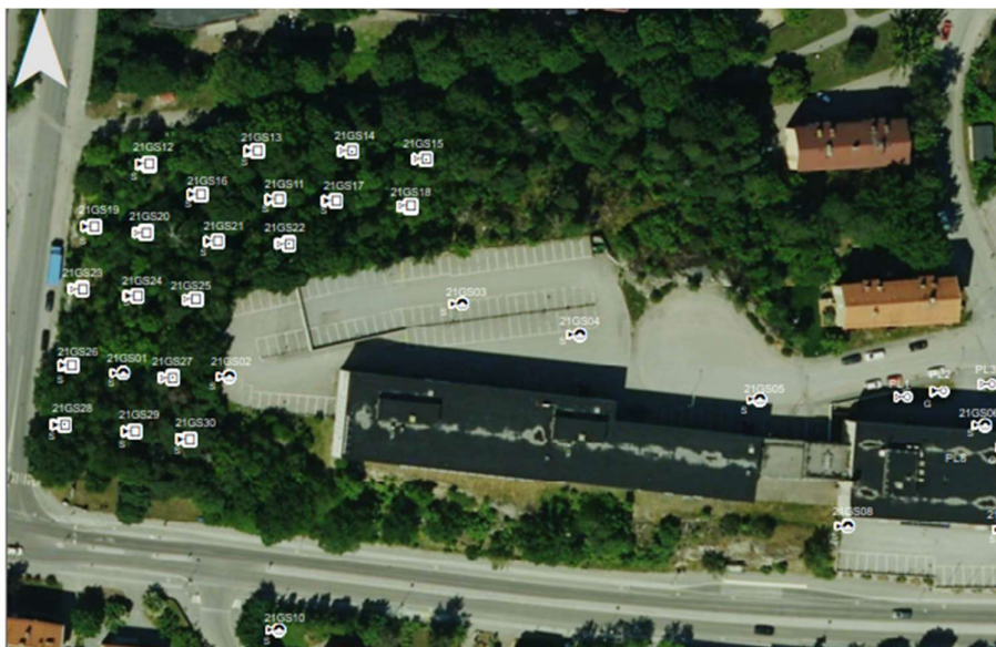
Figur 6 Del av situationsplan, Geosigmas kompletterande undersökning 2021 Fyrkant med triangel representerar provgroppgrävning och cirkel med triangel skruvprovtagning. Källa: Geosigma (2021b).
