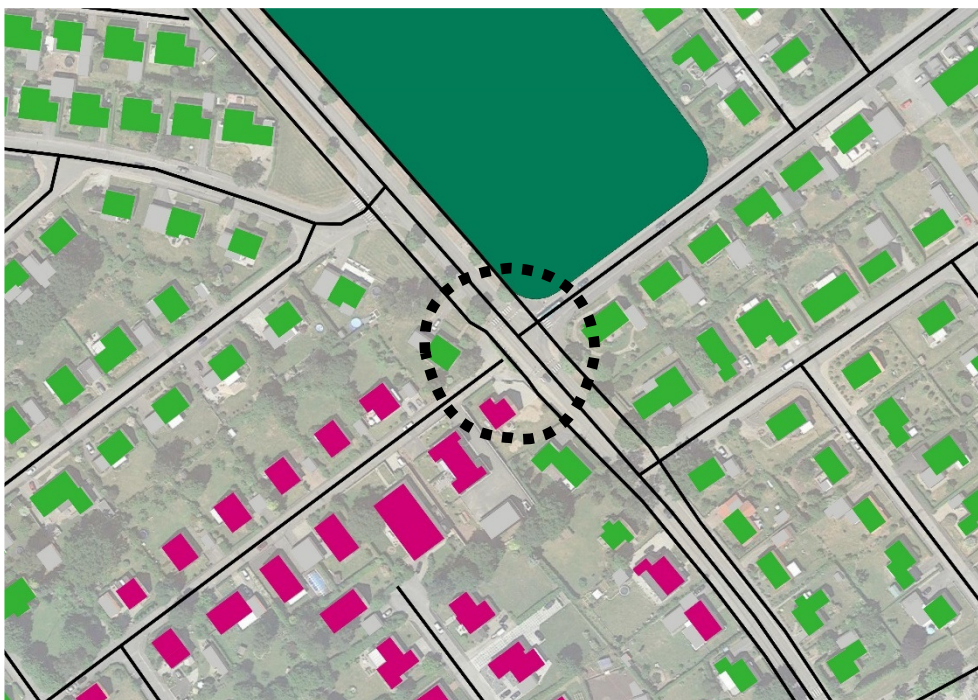
Figur 52 En saknad länk i gångnätet, i detta exempel ett övergångsställe över en väg, resulterar i ett analysresultat där det ser ut som att de som bor i de rosa husen har längre än 300 meter till närmaste grönområde trots att de i verkligheten bor alldeles intill ett.
