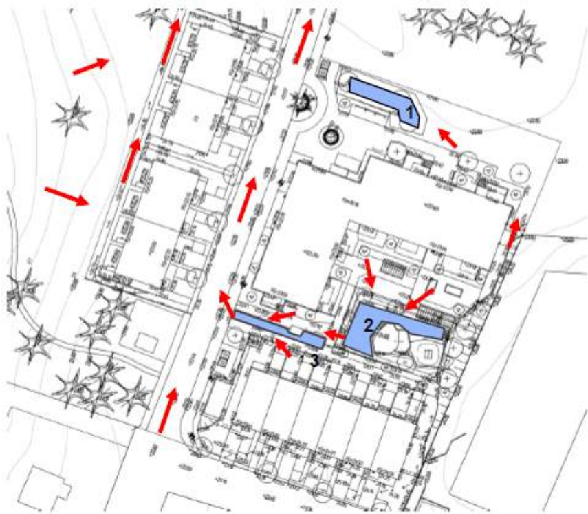
Kartan visar blåa ytor avsedda för hantering av skyfall och röda pilar för den sekundära avrinningen (Sweco, 2026).
