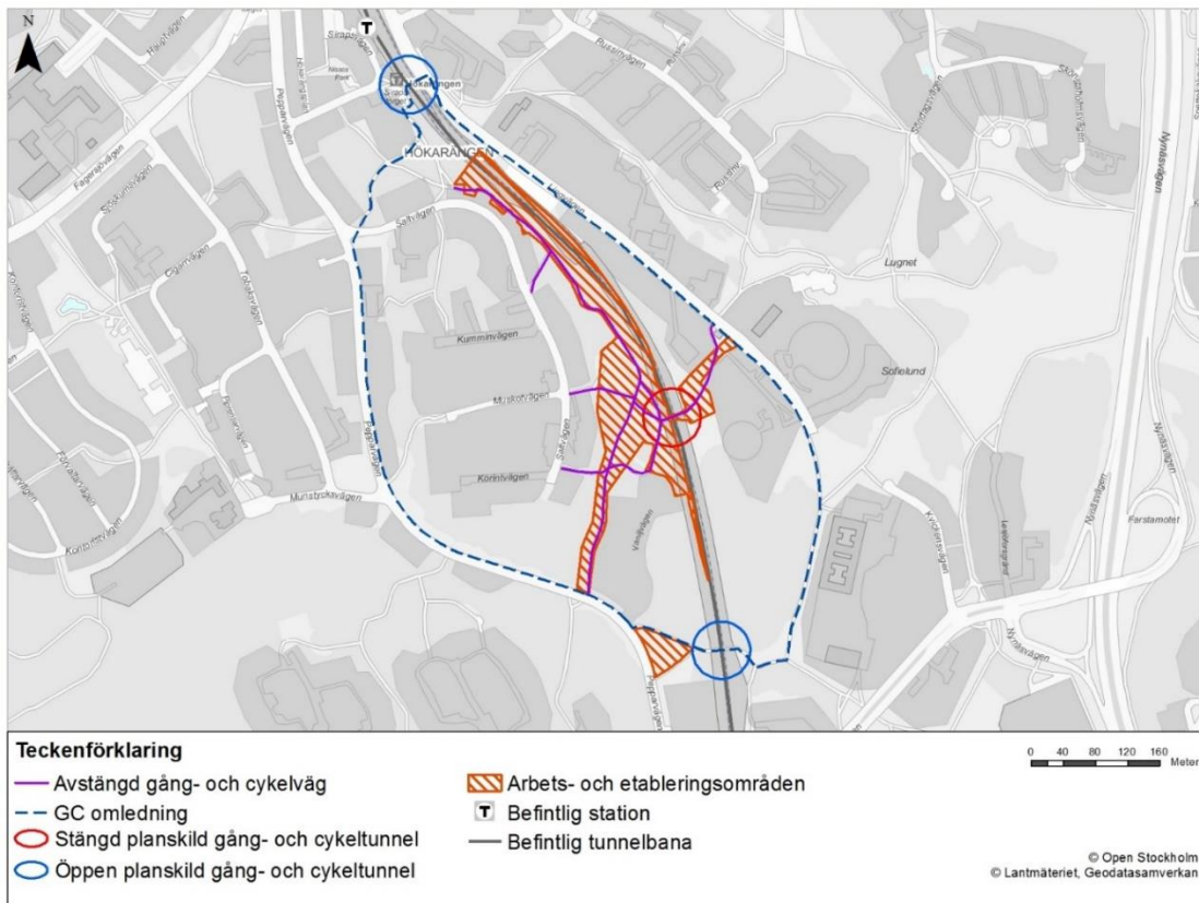
Figur 31. Befintliga gång- och cykeltunnlar vid anslutning till Farstagröden som är öppna och stängda under byggskedet.
