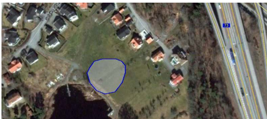
Figur 5. Illustration av ytbehov och möjlig placering av dagvattendamm vid Solvik på knapp 0,2 hektar (våtyta), vilket motsvarar cirka 1 % av avrinningsområdets reducerade yta.
