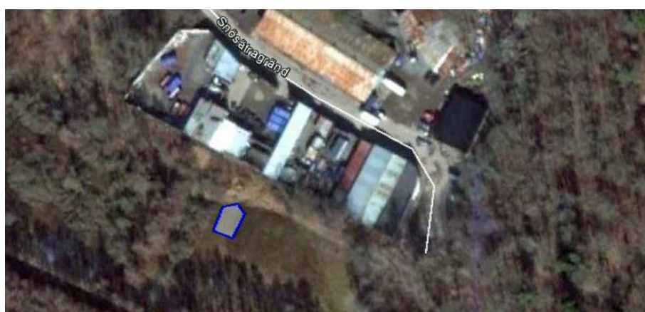
Figur 50. Förslag till placering av en dagvattendamm vid Snösättra på 0,01 hektar (våtyta), vilket motsvarar cirka 1 % av avrinningsområdets reducerade yta.
