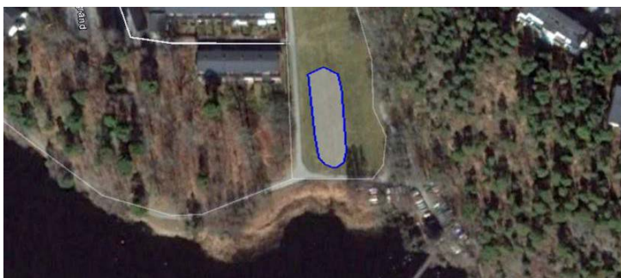
Figur 32. Förslag till placering av dagvattendamm vid Gräsmarksgränd på 0,08 hektar (vätyta), vilket motsvarar cirka 1 % av avrinningsområdets reducerade yta.
