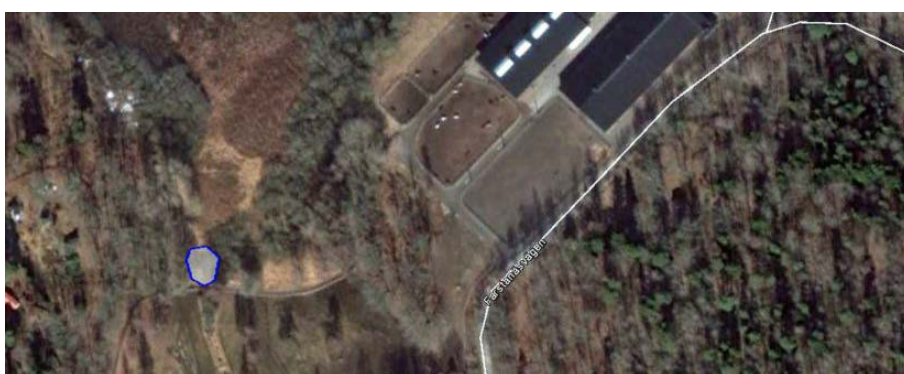
Figur 46. Förslag till placering av en dagvattendamm vid Farsta ridskola på knappt 0,02 hektar (våtyta), vilket motsvarar cirka 10 % av avrinningsområdets reducerade yta.
