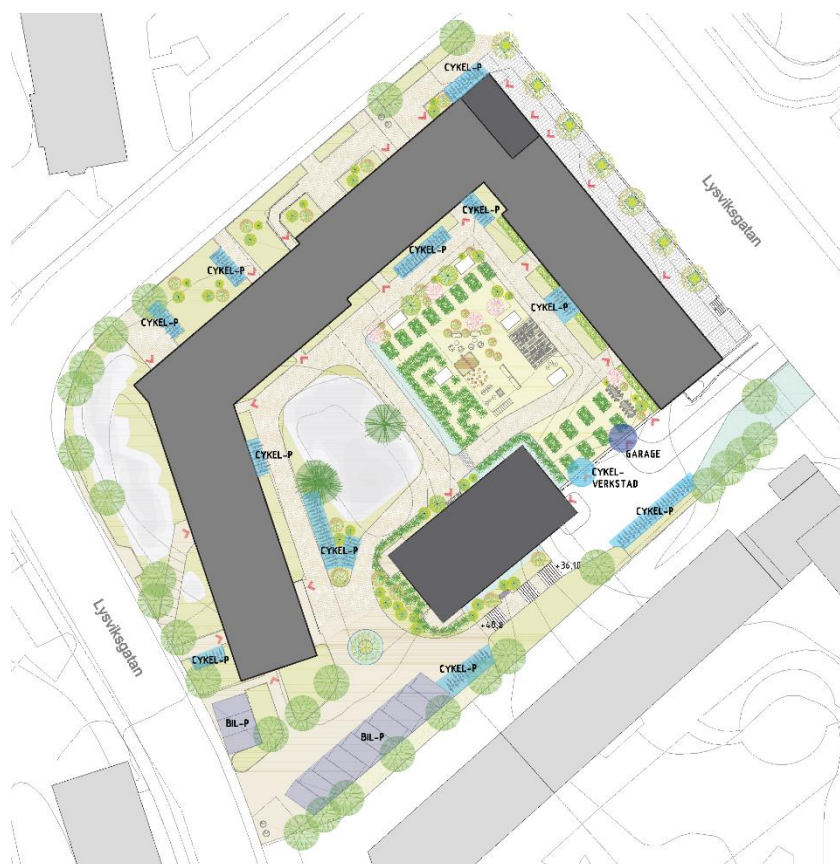
Situationsplan som redovisar läge för cykelparkering med turkos markering och läge för bilparkering i blållila markering. (Bild: Vardag)
