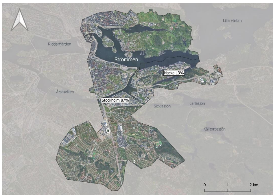
Figur 1. Strömmens tillrinningsområde (totalt 13,5 km 2 ), där Stockholm utgör 87% och Nacka 13% av den totala ytan. I Stockholm finns i vissa delar, ca 30%, ett kombinerat ledningsnät för dag- och avloppsvatten. Dagvattnet från dessa områden leds direkt till reningsverk. Utöver de i kartan markerade områdena sker avrinning från Mälaren. Vattenutbyte sker med Lilla Värtan som i sin tur har vattenutbyte med Brunnsviken, Edsviken, Stora Värtan och Askrikefjärden.
