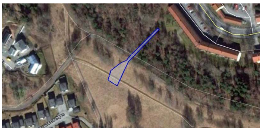
Figur 34. Förslag till placering av en dagvattendamm vid Bjursätra på 0,05 hektar (våtyta), vilket motsvarar cirka 1% av avrinningsområdets reducerade yta.
