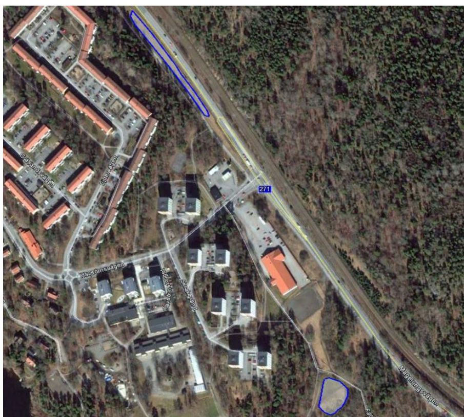
Figur 24. Två förslag till placering av dagvattendammar vid Magelungsvägen respektive Fågelsviksbacken på knapp 0,2 hektar (våtyta) vardera, vilket tillsammans motsvarar cirka 1 % av avrinningsområdets reducerade yta.
