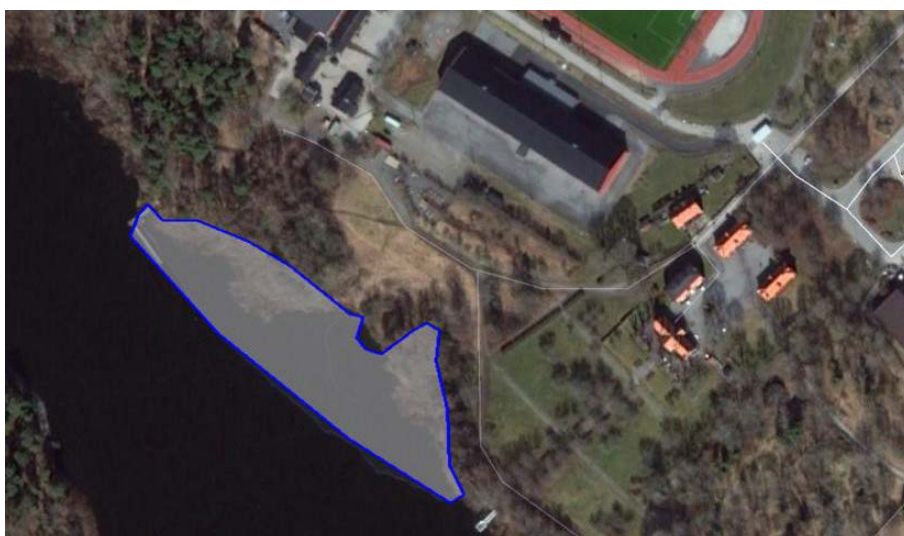
Figur 21. Illustration av den befintliga skärmbassängen vid Farsta IP. Ytan på knappt 0,9 hektar motsvarar cirka 2,5 % av avrinningsområdets reducerade yta. Inpassning är gjord mot tätortskartan vars strandlinje tycks skilja sig något mot hur den ter sig på flygfotot i figuren.
