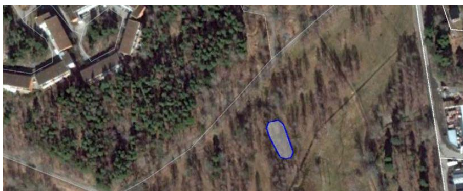
Figur 38. Illustration av ytbehov och placering av en dagvattendamm vid Bäverdalen på 0,04 hektar (våtyta), vilket motsvarar cirka 1 % av avrinningsområdets reducerade yta.
