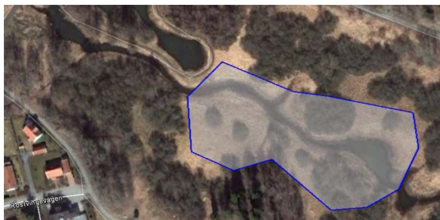
Figur 15. Illustration av en möjlig utvidgning av Kräppla våtmark med 1,1 hektar (våtyta), vilket skulle innebära att anläggningens hela yta motsvarade 1,5 % av avrinningsområdets reducerade yta.
