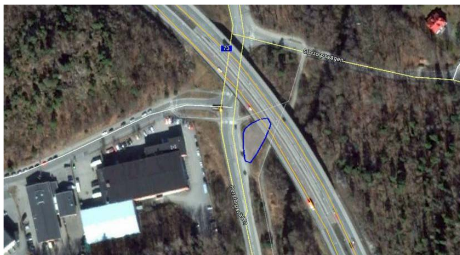
Figur 30. Illustration av ytbehov och ungefärlig placering av dagvattendamm/avsättningsmagasin vid Edsvallabacken på knapp 0,1 hektar (våtyta), vilket motsvarar cirka 1 % av avrinningsområdets reducerade yta.
