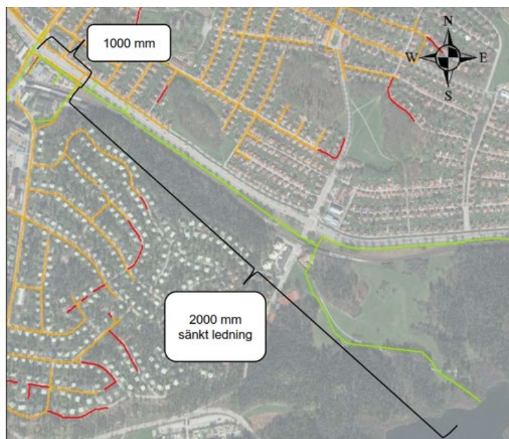
Figur 1. Åtgärdsförslag B1a för att klara behövd kapacitet vid duplicering och vidare exploatering vid Islandstorget, skulle innebära att befintliga ledningar byts ut till dimensionerna 1000 mm och 2000 mm.
