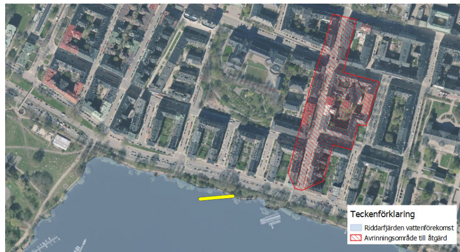
Figur 6. Föreslagen placering av rörmagasin, med inlopp på land och övrig rördel i vattenområdet. Avrinningsområdet till åtgärden är markerat med rött streckat område.
