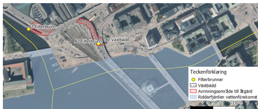
Figur 2. Föreslagna åtgärdsplatser för rening av vatten från centralbron i filterbrunnar och/eller växtbädd samt lokalt avrinningsområde till reningsanläggning.
