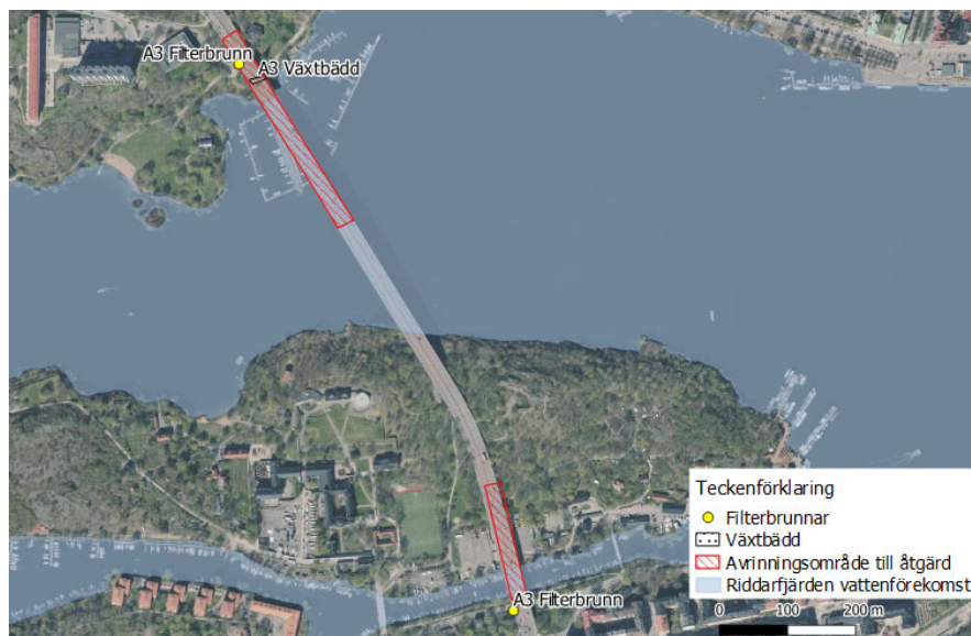
Figur 3. Föreslagen åtgärdsplats för rening av dagvatten från Västerbron samt lokalt avrinningsområde till reningsanläggningarna för filterbrunnar och växtbädd.
