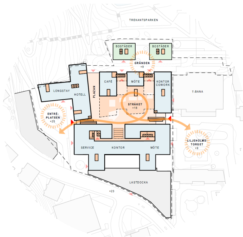
Principillustration över hur inomhusstråket kopplar samman torget, entréplatsen och gränden men fungerar även som mötesplats. (bild: Reflex arkitekter)
