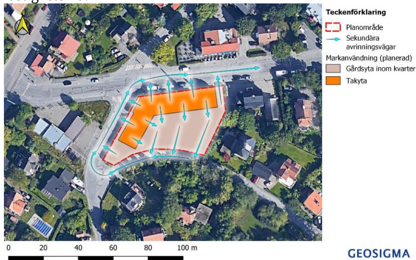
Bilden visar åtgärdsförslag för sekundära avrinningsvägar (Geosigma, 2020)
