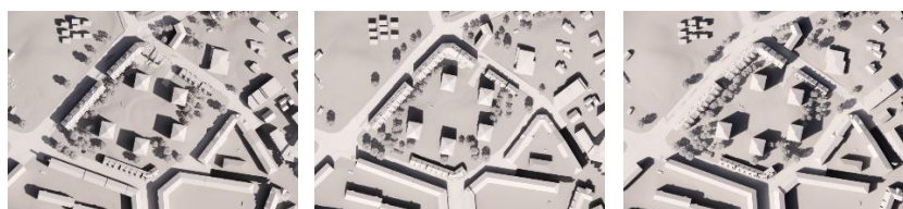
Solstudier för delområde 1 och 2, sommarsolstånd, kl. 9 (bild till vänster), kl. 12 (bild i mitten) och kl.15 (bild till höger). Bild: Arkitema
