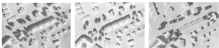
Solstudier för delområde 3 och 4, sommarsolstånd, kl. 9 (bild till vänster), kl. 12 (bild i mitten) och kl.15 (bild till höger). Bild: DinellJohansson
