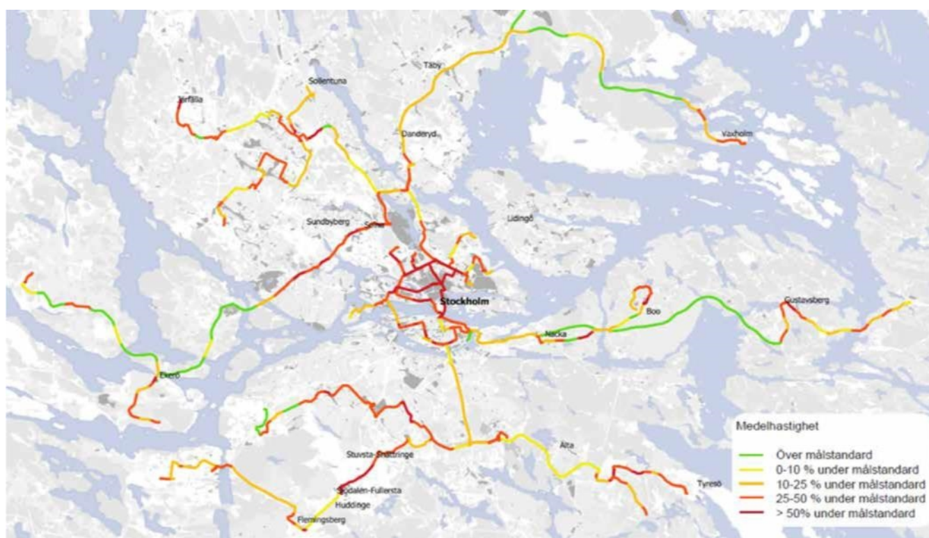
Figur 6 Uppfyllande av målstandard för medelhastighet längs dagens stombussnät, källa: Stombussboksut 2019.
