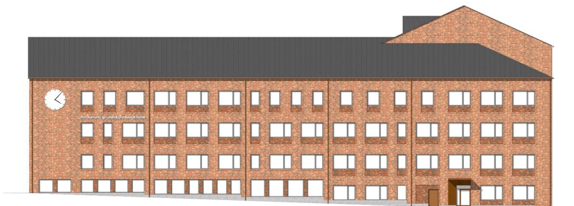
Fasad mot sydväst som möter Tellusborgsvägen. I bottenvåning syns stora fönsterpartier, en av byggnadens sekundärentréer samt dörr till miljörum. Illustration av Liljewall arkitekter.
