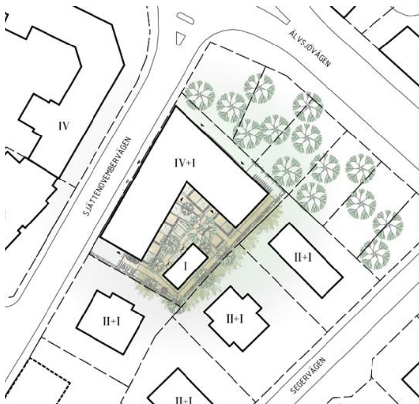
Situationsplan, planområdets norra del med ny bebyggelse. Romersk siffra anger antal våningar. Bild Robert Sandell Arkitektkontor.
