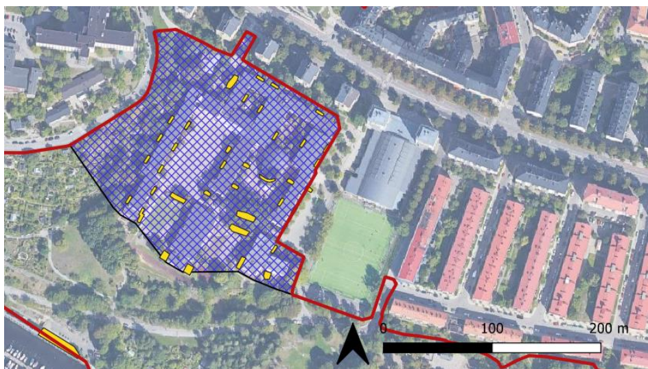
Figur 7. Tillrinningsområdet för dagvatten (blått), ett principförslag för placering och storlek på åtgärdsytor (gult) samt möjlig placering av en 300 kvadratmeter stor skärmbassäng (gult).
