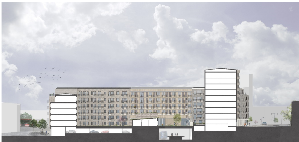
Kvarteren som överdäcker tunnelbanespåret. Sektion från väst, Hägerstensvägen till höger. Illustration: Lindberg Stenberg Arkitekter
