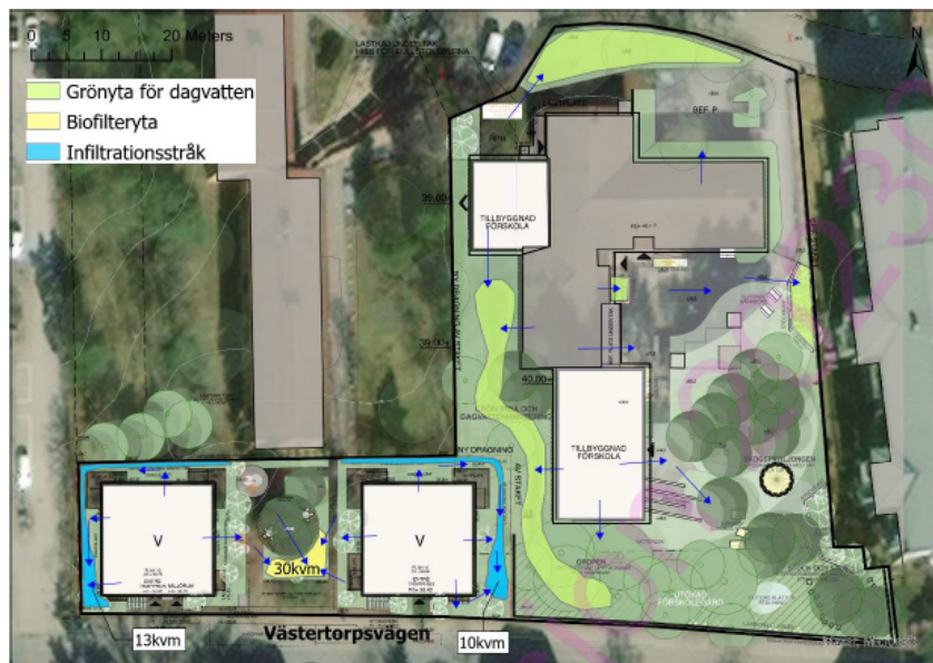
Föreslagna åtgärder för hantering av dagvatten i östra kvarteret. Tyréns
