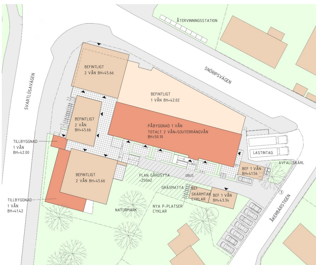
Illustrationsplan. Mörkare orangea ytor visar tillkommande på- och utbyggnader. (Bild: Jonas Fahlbeck Arkitektkontor)
