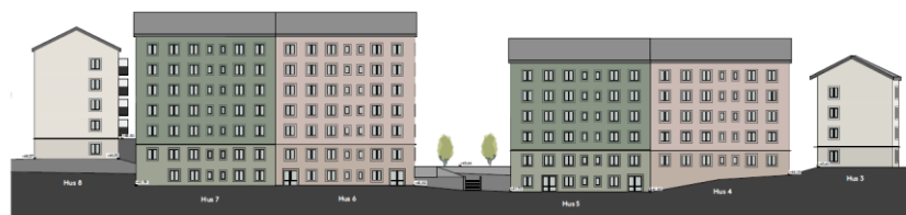
Fasader mot Åbyvägen. Mellan huskropparna ansluter en trappa till gården (bild: ÅWL).
