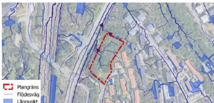
Flödesvägar och lågpunkter med föreslagen höjdsättning. Pilarna visar flödesriktningen (Bild: Ramböll).
