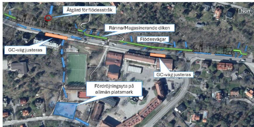
Illustration föreslagen systemlösning skyfallshantering för södra området. Bild WSP
