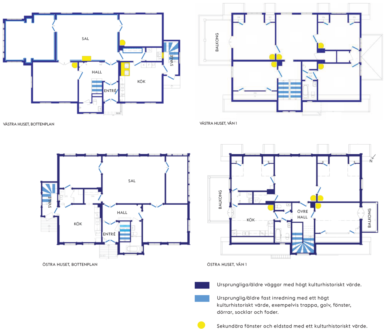
Bild 15. Planritningar som illustrerar väggar, fast inredning, fönster och eldstäder av kulturhistoriskt värde. Planritningarna i de två övre bilderna visar det västra huset och i de nedre bilderna visas det östra huset.
