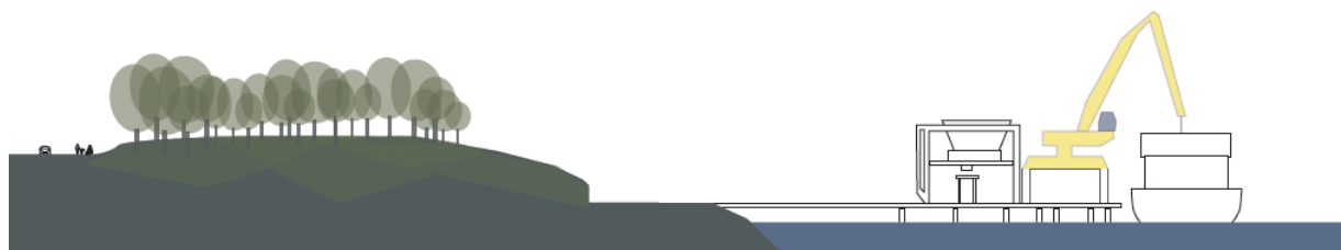
Principsektion hamn. Kyrkhamnsvägen till vänster. Kaj på pålar i Mälaren med kranar som lyfter bränsle från fartyg till transportband. Illustration: Liljewall Arkitekter.
