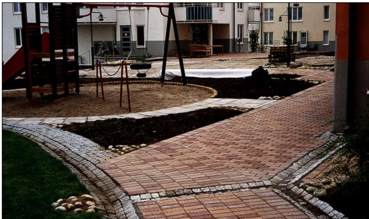
Figur 5-2: Exempel på avledning av takvatten via rännor anlagda med gatsten (Källa: Stockholm Vatten AB, n.d.).
