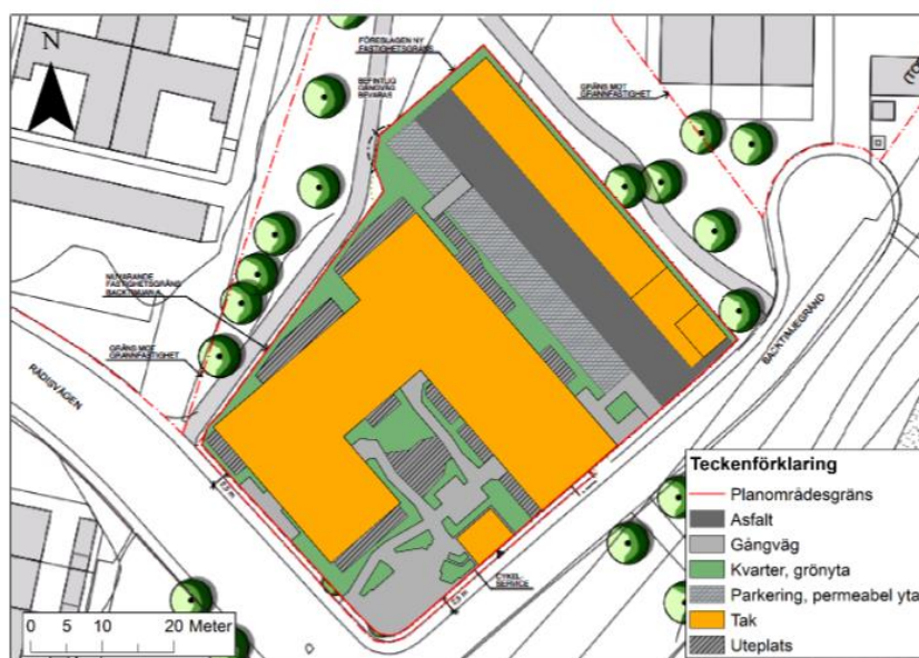
Bild 19. Principskiss på planerad markanvändning med ungefärlig placering av föreslagna lösningar för dagvattenhantering
