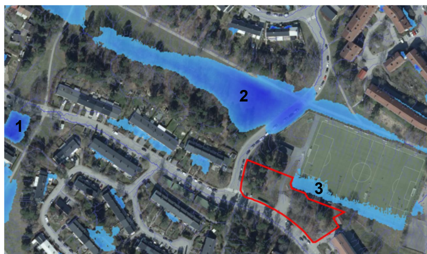
Lågpunkter som påverkas vid större nederbördstillfällen. WSP
