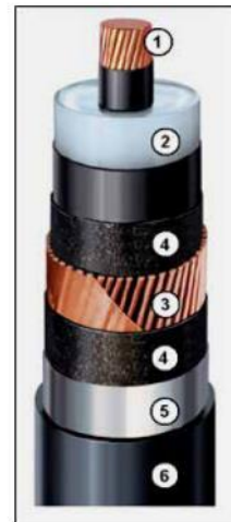
Figur 16. Kabel i genomskärning. 1) ledare, 2) isolation, 3) koppartråd, 4) svällband, 5) aluminiumfolie, 6) polyeten. Kabelns ytterdiameter är 150 mm.
