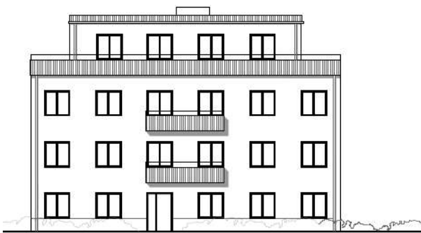
Fasad mot öst. Balkonger centreras över entré på husets långsida.
