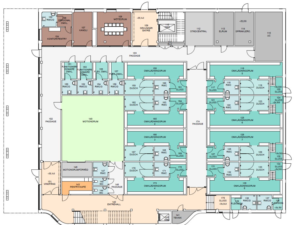
Planritning, plan 1. På våningen finns omklädningsrum, lokaler för drift, teknik och personal, bokningsbart mötesrum och kansli, motionsrum, bokningsbart föreningscafé.
