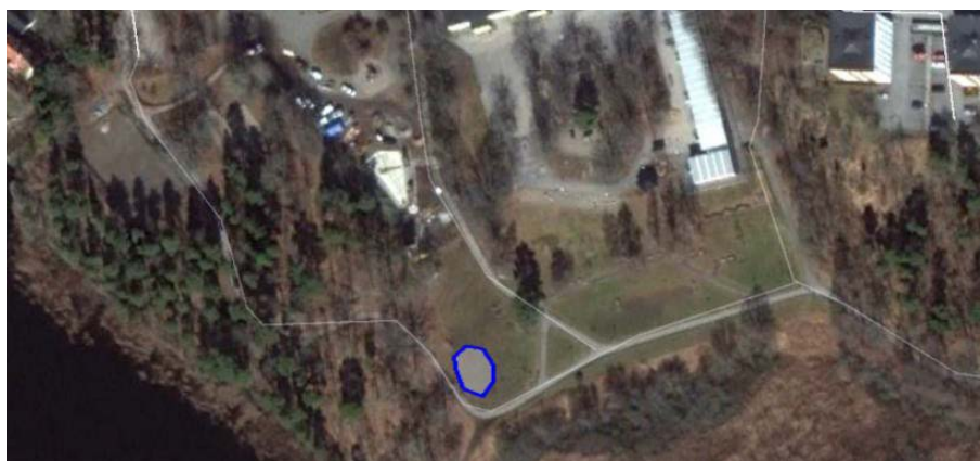
Figur 44. Förslag till placering av en dagvattendamm vid Fagersjöskolan på O,02 hektar (våtyta), vilket motsvarar cirka 1 % av avrinningsområdets reducerade yta.
