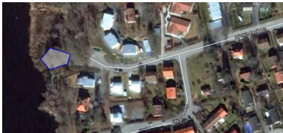
Figur 40. Förslag till placering av en dagvattendamm vid Rödkindavägen på 0,05 hektar (våtyta), vilket motsvarar cirka 1 % av avrinningsområdets reducerade yta.
