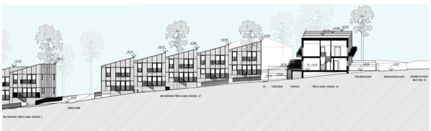
Sektion A2 visar hur planförslaget förhåller sig till och följer platsens topografi. Bild: Arkemi
