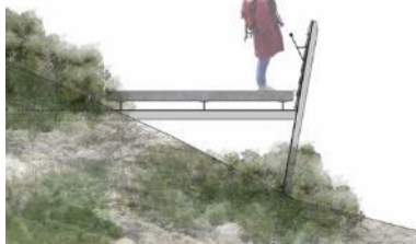
Stora Stadshagstrappan. Lätt konstruktion som följer terrängen med räcke i framkant mot utsikten.
