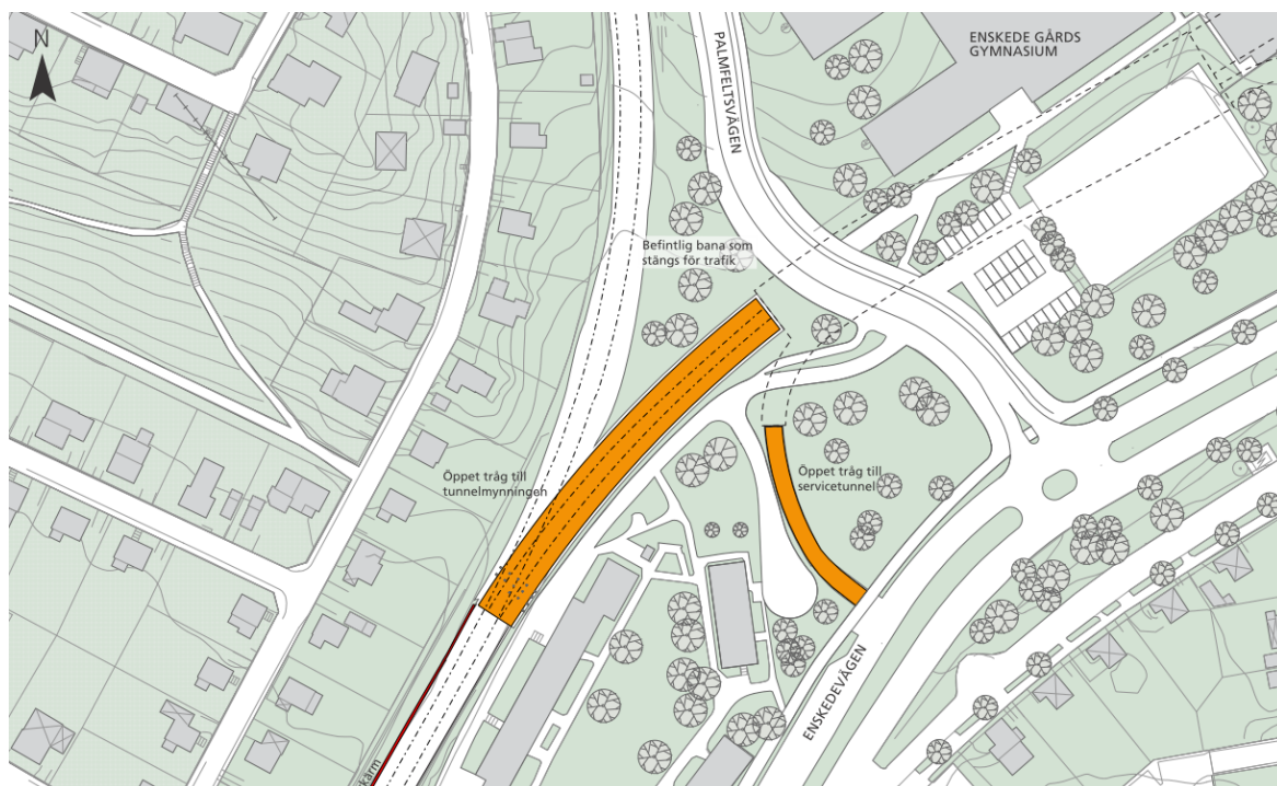
Anslutning till befintligt spår, norr om Sockenplan, situationsplan. Anläggningar ovan mark markerade med orange.
