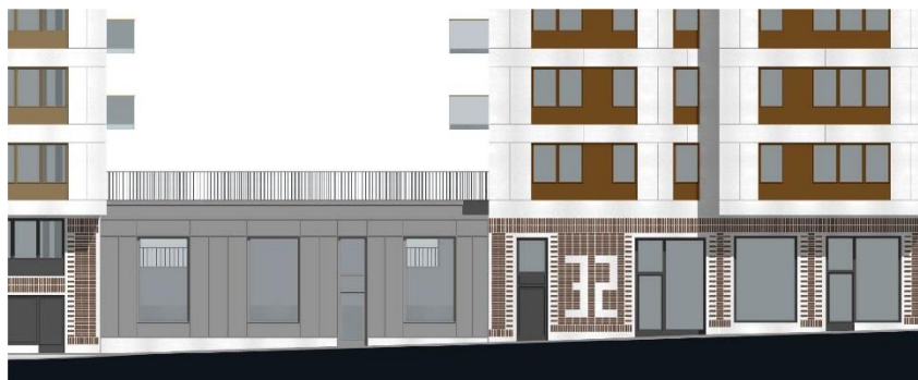
Tydlig sockelvåning mot lokalgatan vid Karlsbodavägen. Lokaler i delar av bottenvåning. ÅWL arkitekter.
