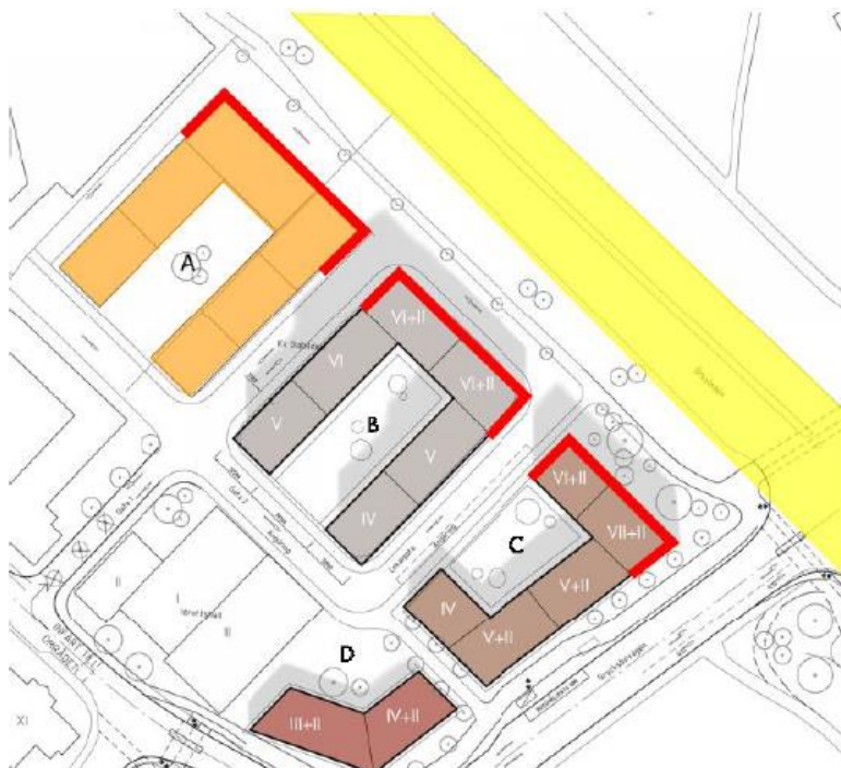
Fasader som ska utföras i brandteknisk klass EI 30 är schematiskt markerad med rött. (Källa: Prevecon)
