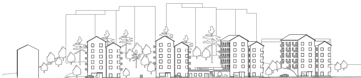
Figur 19. Fasadelevation längs Tavelsjövägen. Visar hur planförslaget fortsätter det gavelmotiv som det befintliga lamellhuset mot Årstavägen påbörjar längs Tavelsjövägens början. De nya husen är rytmiskt placerade längs gatan med mellanrum mellan husen vilka utgörs av bevarad naturmark och i mitten en garagebyggnad i en våning med bostadsgård ovanpå. Bild: Arkitektstudio Witte.
