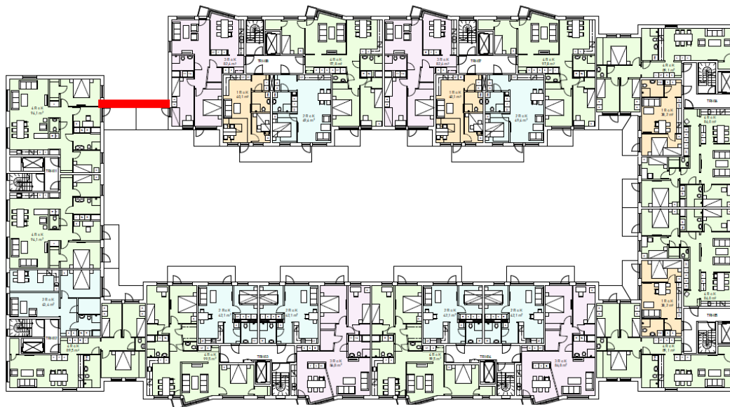
Planlösning för normalplan i bebyggelseförslaget, nödvändig glasing markerad med rött (Brunnberg & Forshed).
