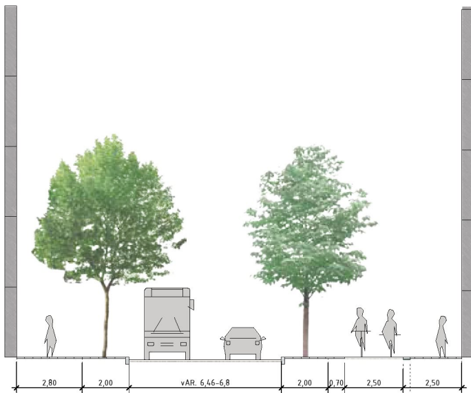
Typplan- och sektion för Hangövägens utformning
