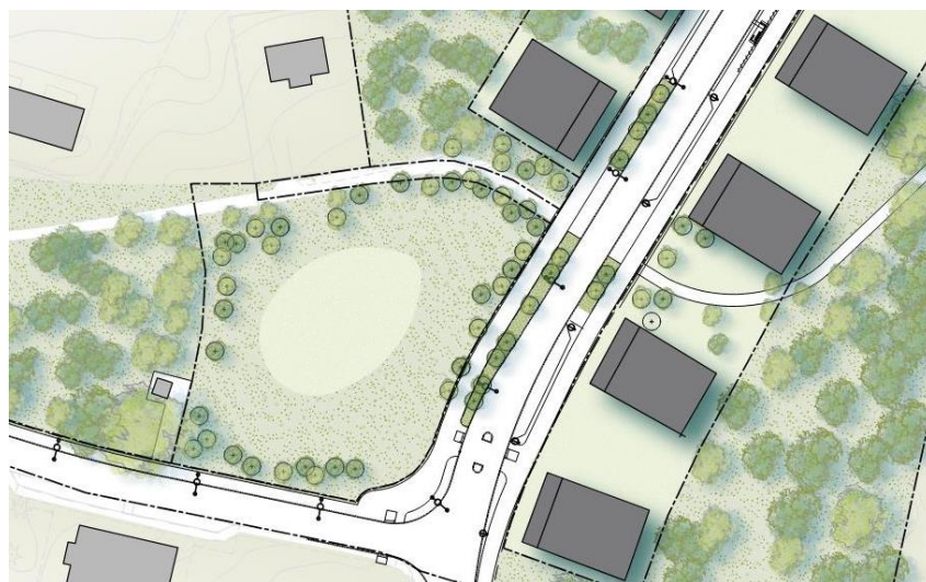
Gemensam park norr om korsningen Blackebergsvägen/Blackebergsbacken. Till höger i illustrationen syns gångvägen som får en ändrad sträckning och passerar mellan bebyggelsen. (Tengbom/Stockholms stad)
