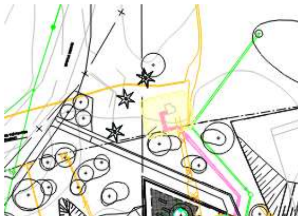
Anslutning av ny fjärrvärmeledning (rosa linje) till befintlig anläggning.
