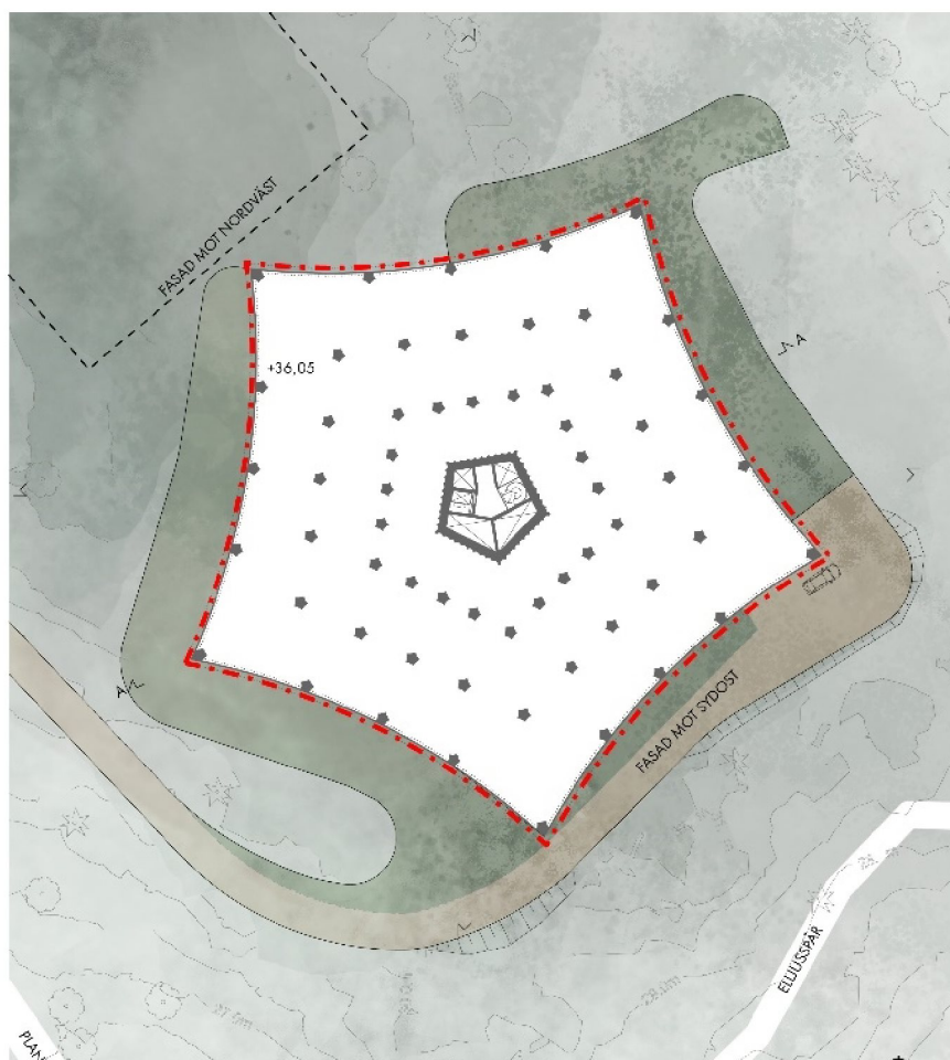
Plan 1 redovisar mittornet och pelarna, som utförs med ett femhörnt tvärsnitt med konkava sidor.
