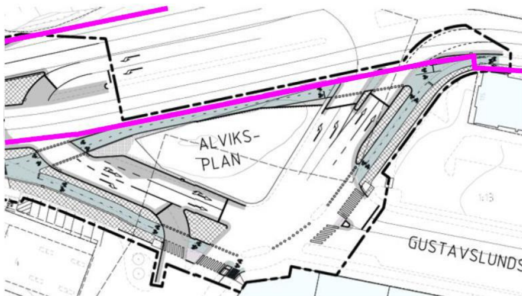
Figur 13. Planutsnitt över ny cykelbana rakt fram förbi Alviksplan mot Tranebergsbron och breddade befintliga gång- och cykelbanor.
