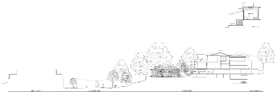
Sektion genom Musikpaviljongen och huvudbyggnaden med verandan. Till vänster om Djurgårdsvägen syns ABBA-museet. Utsnittet uppe till höger visar en uppförstoring av verandan. Källa: Lundgaard & Tranberg Arkitekter
